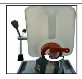
Откройте кран бака с водой, как это показано на картинке и осторожно с помощью ручки опустит машину вниз.
