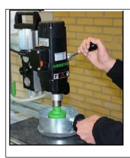
Положите плитку или плиту на стол и отрегулируйте ее в необходимом положении. Зафиксируйте заготовку с помощью держателя (он также выполняет функцию брызговика).
