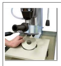
Для сверления диаметром до 40 мм. необходимо использовать в столе кольцо-переходник. Стол можно снять при выполнении сверления диаметром больше 40 мм.
