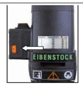
Машина оснащена регулятором скорости, позволяющим плавно регулировать скорость от 250 до 1000 об/мин. Длительное использование станка низкой скорости привести может внезапному (преждевременному) отключению инструмента, поскольку мотор поступает меньше охладительного воздуха и он, соответственно, быстрее перегревается.
