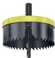
Пильная коронка, цельная, тяжёлый несущий диск из цинкового литья под давлением, пильные венцы из закалённой пружинной стали, для работы по дереву, древесностружечным плитам, гипсокартону и лёгким строительным плитам.
