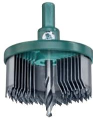
С запатентованными пазми для лучшей производительности. Пильная коронка, 8 частей, несущие диски изготовлены методом литья под давлением из цинкового сплава, режущий венец - из закалённой пружинной стали с индуктивно закалёнными концами зубьев. Пильная коронка применяется для работы с деревом, покрытой пластиком древесиной, твёрдым деревом, древесностружечными плитами, гипсокартоном, облегчёнными плитами, пластиком и медью.
