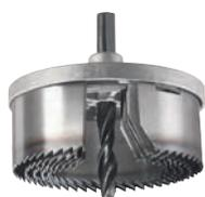
Пильная коронка, из 5-ти предметов, тяжёлый несущий диск из цинкового литья под давлением, пильные венцы из закалённой пружинной стали, для работы по дереву, древесностружечным плитам, гипсокартону и лёгким строительным плитам.
