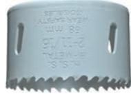
Биметаллические пильные коронки из быстрорежущей стали, зубья с прогрессивным шагом, для ускоренного выброса стружки, зубья из быстрорежущей стали, легированы 8% КОБАЛЬТА, чрезвычайно износостойкие, высокий срок службы, для работы по стали, серому чугуну, конструкционной стали, нержавеющей стальным листам, алюминию, бронзе, меди, пластику, акрилу, гипсокартону и дереву.
