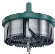
С запатентованными пазми для лучшей производительности. Пильная коронка, 7 частей, несущие диски изготовлены методом литья под давлением из цинкового сплава, режущий венец - из закалённой пружинной стали с индуктивно закалёнными концами зубьев. Пильная коронка применяется для работы с деревом, покрытой пластиком древесиной, твёрдым деревом, древесностружечными плитами, гипсокартоном, облегчёнными плитами, пластиком и медью.
