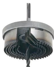
Пильная коронка, из 7-ти предметов, несущий диск из алюминиевого литья, пильные венцы из закалённой пружинной стали, для работы по дереву, гипсокартону и лёгким строительным плитам.
