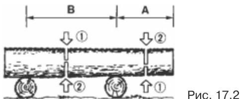
В области «А» (рис. 17.2) выполните распил сверху вниз на одну треть и закончите распил снизу вверх. В области «В», выполните распил снизу вверх на одну треть и закончите распил сверху вниз.
