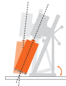
нежесткое закрепление сверлильной установки к бетонному основанию
