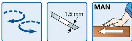
> Корпус имеет посадочные отверстия для установки фасочных ножей для прямых фасок IG61MS или радиусных фасок IG62MS (R = 1,5 - 2 - 3 mm).
