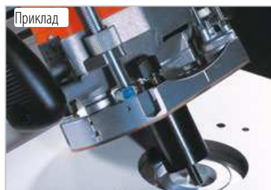
999.502.34 Центруючий механізм дозволяє швидко та точно встановлення фрезера
